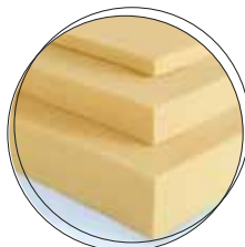
PUR/PIR (Espuma Rígida de Poliuretano ou de Poli-isocianurato). condutibilidade: 0,040
