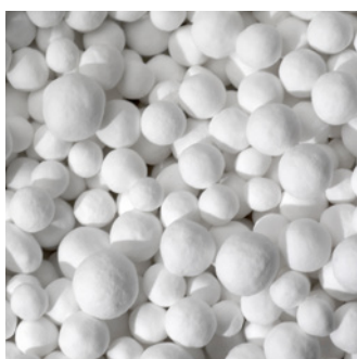
Fig.24- Tipos de dessecantes dos secadores de adsorção
